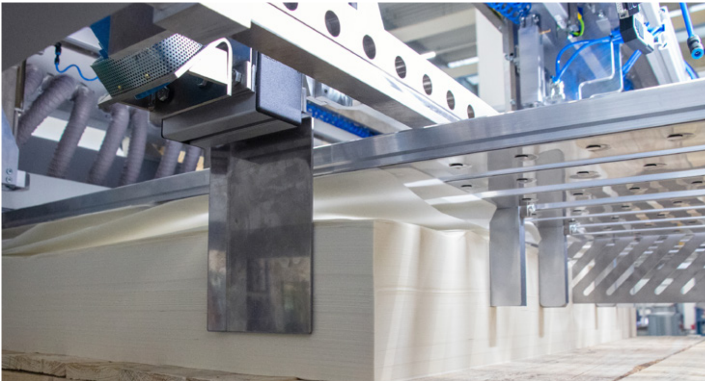
Die Airstream-Luftleisten-Technologie sorgt für einen außerordentlich sicheren Durchlauf jedes einzelnen Bogens und ist daher ideal für empfindliche oder bedruckte Spezialpapiere.
