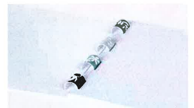
Verklebung der Lasche auf dem Buchrücken. Die Papierspirale ist auch beim geöffneten Buchblock sichtbar. Gluing the strip to the spine of the book. The paper spiral is also visible when the book block has been opened.
